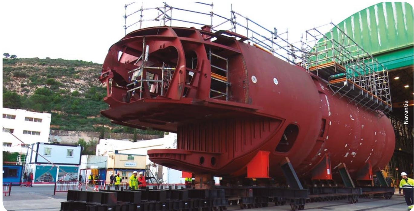
Proa del submarino S-80 Plus en la que se aprecia el espacio reservado para el sonar cilíndrico | Bow of the S-80 Plus submarine showing the space reserved for the cylindrical sonar
