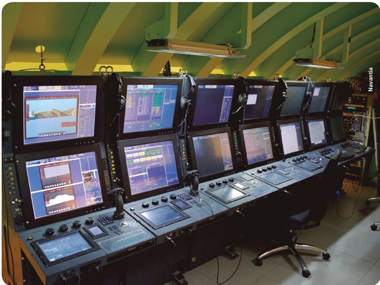
Consolas del simulador táctico del submarino | Consoles in the tactical submarine simulator
