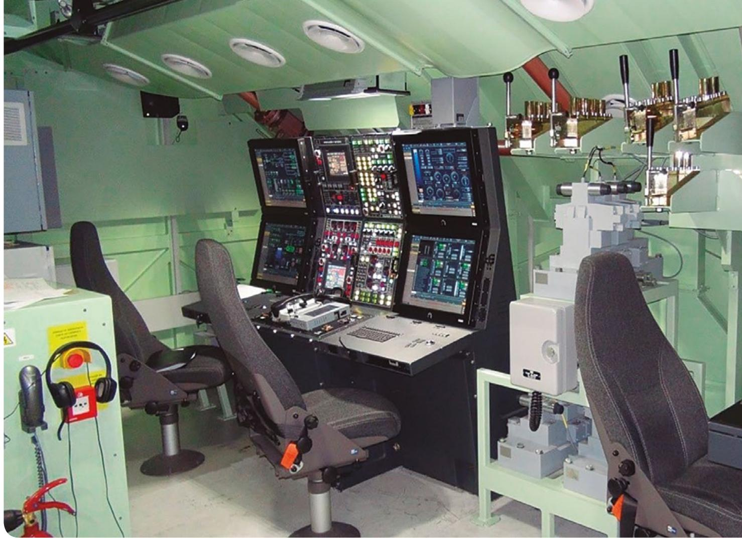
Simulador de control de plataforma del S-80 Plus | S-80 Plus platform management simulator
