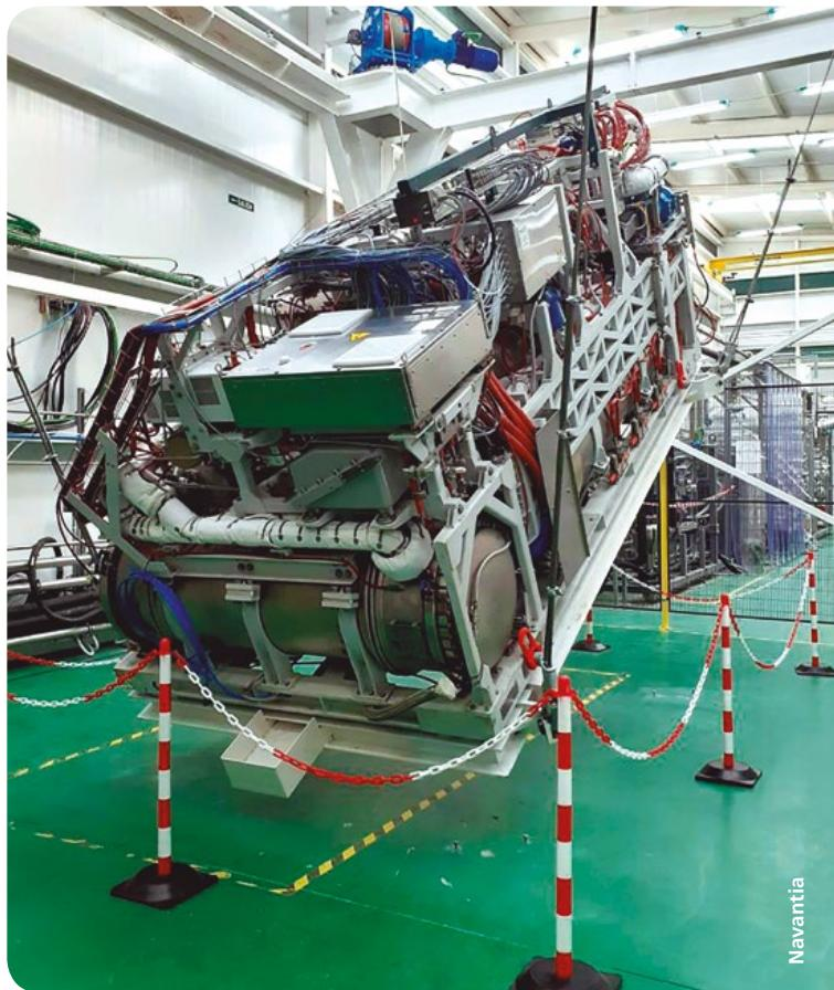
Procesador de bioetanol en pruebas de movimientos de plataforma | Bioethanol processor in motion platform tests
